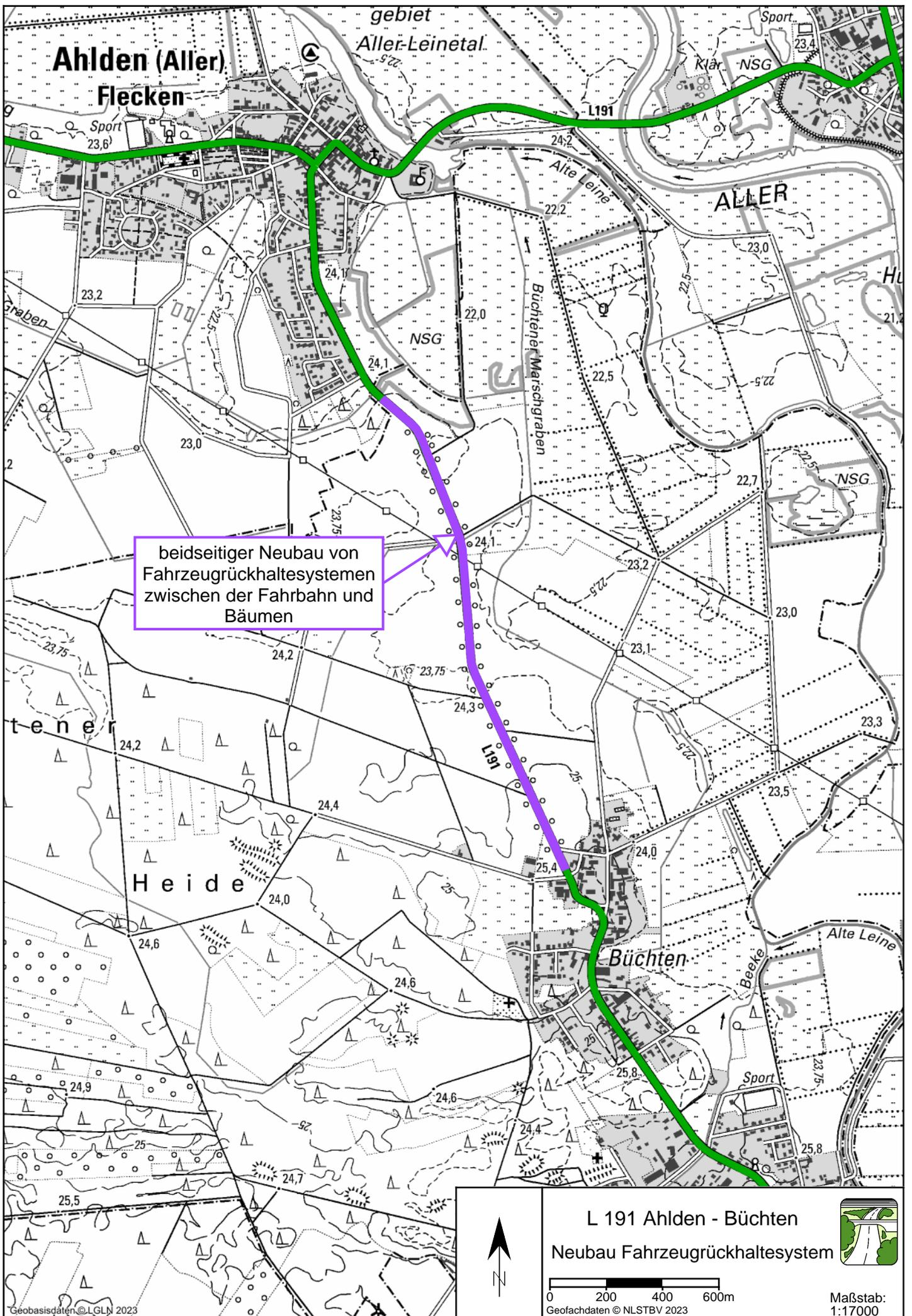
beidseitiger Neubau von Fahrzeugrückhaltesystemen zwischen der Fahrbahn und Bäumen
